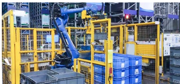
某大型汽配厂 视觉引导周转箱拆垛
