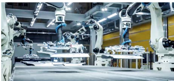
某大型汽车主机厂 视觉引导冲压件下料装筐
