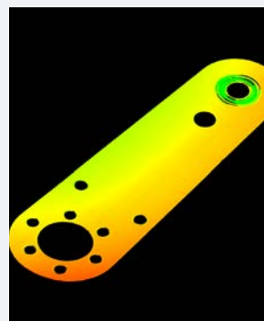
金属板材平面度检测
