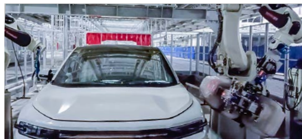
某大型汽车主机厂 3D 视觉引导座椅投放
